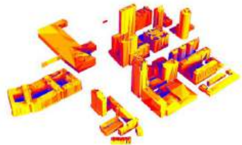
Met een parametrisch low-code script kan een zonlichtanalyse worden gemaakt
